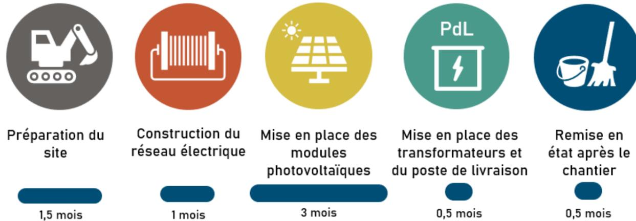
Figure 1 : Durées approximatives et phases de travaux de construction d'un parc photovoltaïque
